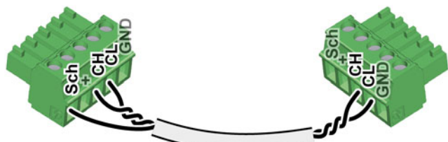
Sl. 10-3: Vod vodila CAN (2-žilni, enostransko oklopljen)
