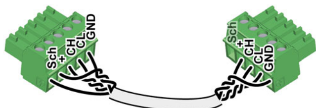
Sl. 10-4: Vod vodila CAN (4-žilni, enostransko oklopljen)
