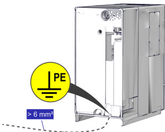
Sl. 10-1: Izvrtina za priključitev izenačitve potenciala
